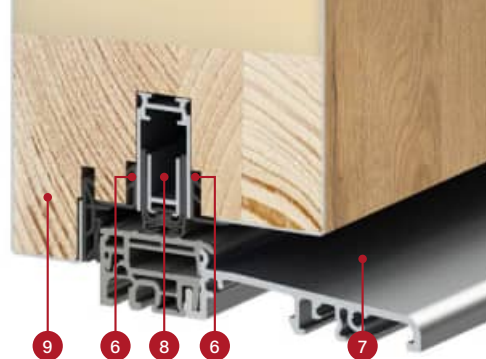
durvju vērtne THERMO HOT 88 ar nolaižamo blīvi uz bez tās šķērsgriezums, alumīnija sliekšnis
